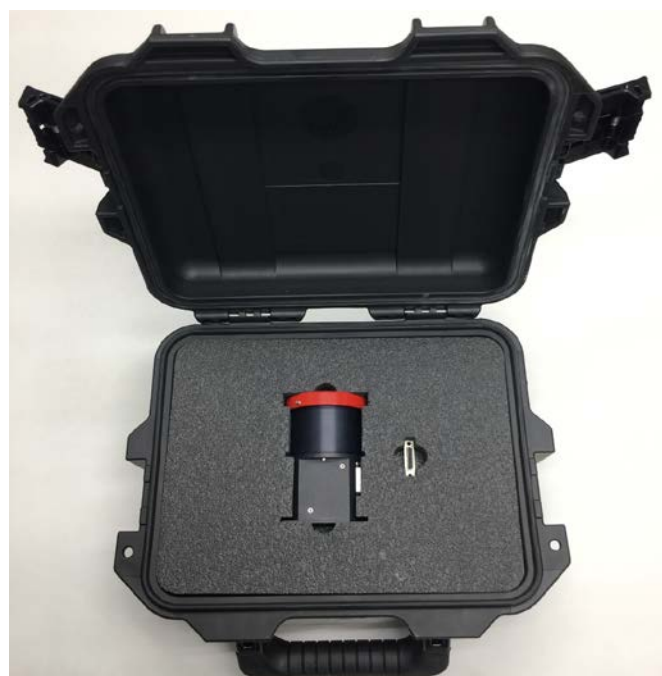
Рис. 2 Малогабаритный звездный датчик АЗДК-1 в упаковочной таре.
