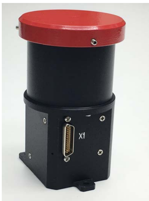
Рис.1 Малогабаритный звездный датчик АЗДК-1.
